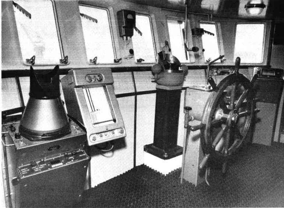
FIG. 2. — La timonerie : au premier plan à gauche l'écran du radar Decca et le sondeur SCAM 610, derrière la barre la commande (peu visible) des moteurs et du pas de l'hélice, à droite celle du gouvernail actif.
