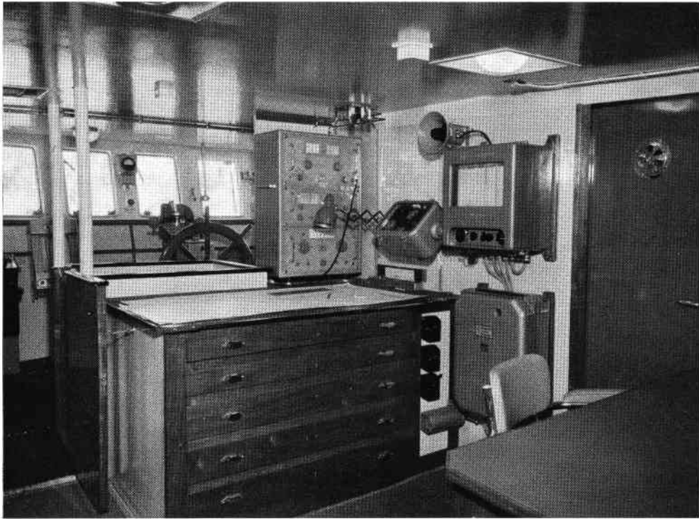
FIG. 3. — La chambre des cartes : sont visibles le meuble à cartes, la radio, l'appareil de navigation Decca et le sondeur Tiefseelot.
