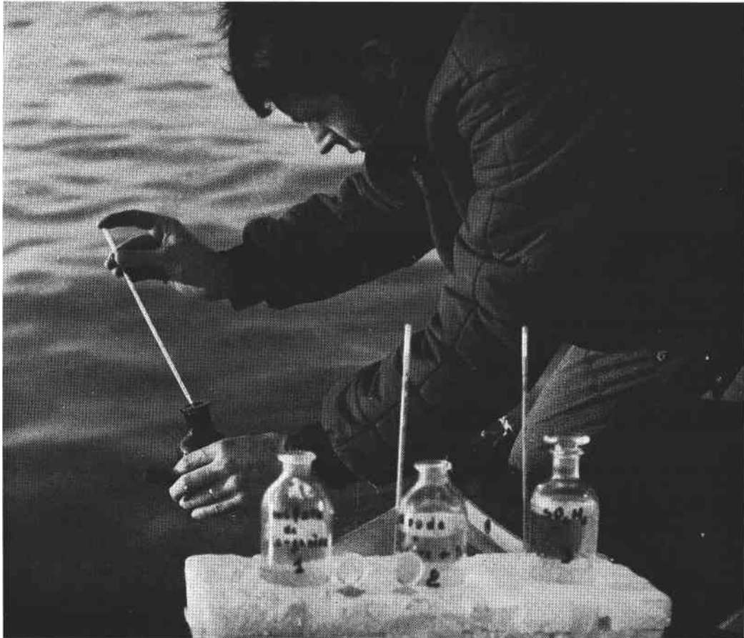
FIG. 2. — Dosage de l'oxygène dissous, méthode chimique, phase initiale : introduction immédiate des réactifs dans la bouteille de prélèvement.
