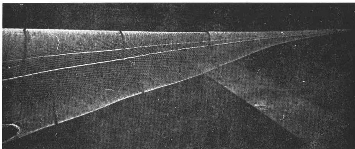
FIG. 8 et 9. — *Entête* (en haut) et *corps* du *chalut semi-pélagique* (en bas) avec une *différence trop grande*. On remarque l'ouverture exagérée des mailles de l'aile inférieure et la courbe de la tête ainsi que la poche qui se forme dans la partie inférieure de l'amorce.
