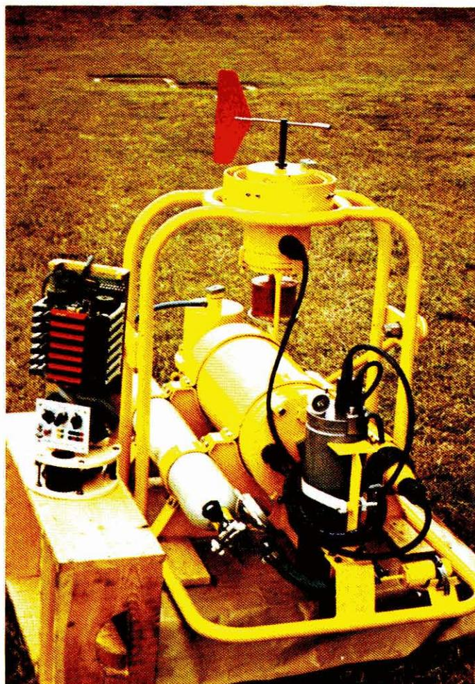
Ph. 2. — Configuration faible profondeur électronique apparente.
