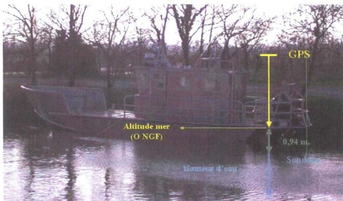
Figure 2 : Acquisition bathymétrique : principe de la mesure.
