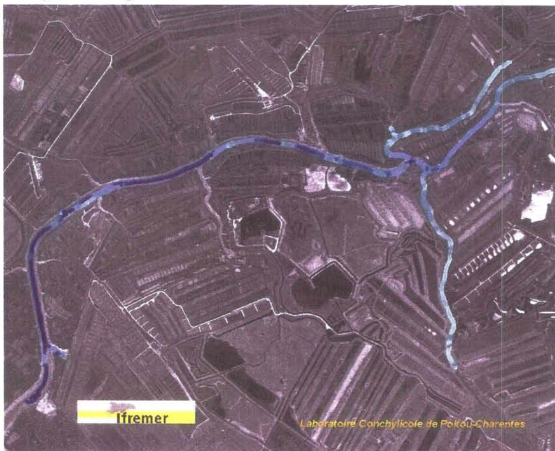
Figure 5 : Acquisition ponctuelle de données bathymétriques le long du chenal de Luzac.
