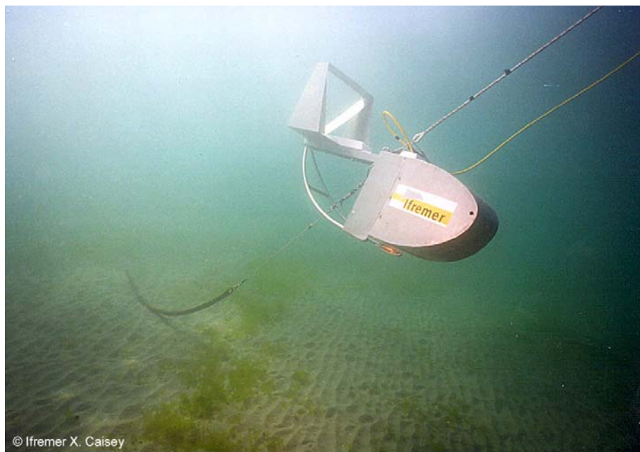
Figure 3. Le poisson vidéo remorqué en action.
