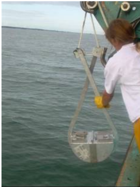
Figure 11. Manipulation de la benne Van Veen à bord de l'Optimist (à gauche) et de la benne Smith McIntyre à bord du Tzigane II (à droite).
