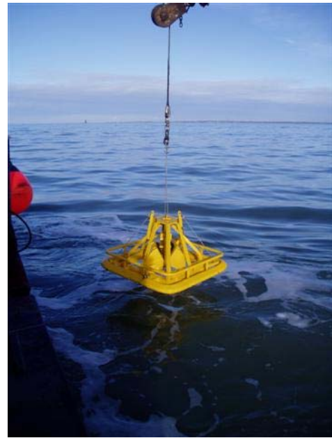
Figure 11. Manipulation de la benne Van Veen à bord de l'Optimist (à gauche) et de la benne Smith McIntyre à bord du Tzigane II (à droite).
