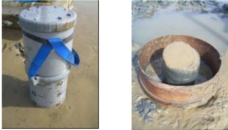
Figure 9. Carottier enfoncé jusqu'à 20 cm de profondeur, diamètre de 12,5 cm (à gauche) et échantillon récupéré sur le tamis (à droite).
